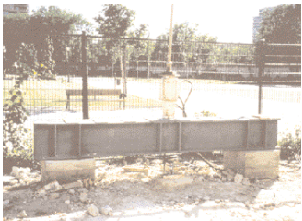
FOTO 3. Yugo del ensayo a tracción de micropilotes.
