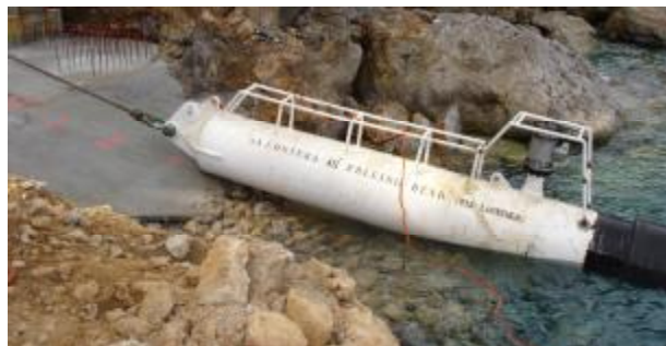
Terminal del pig que queda instalado en la arqueta de Sa Costera
