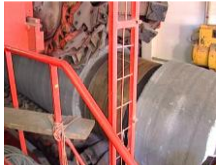
Equipo tensionador para movimiento de las tuberías
